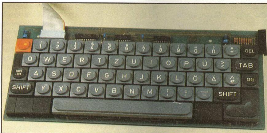
**Bild 62: Die Tastatur ist in Form einer Matrix organisiert, an deren Kreuzungspunkten jeweils eine Taste liegt, die die jeweilige Zeilen- und Spaltenleitung kurzschließen kann.**
