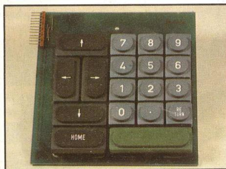
**Bild 65:** Die Tastatur-Erweiterung vervollständigt die auf der Mutterplatine angeordnete Tastenmatrix.
