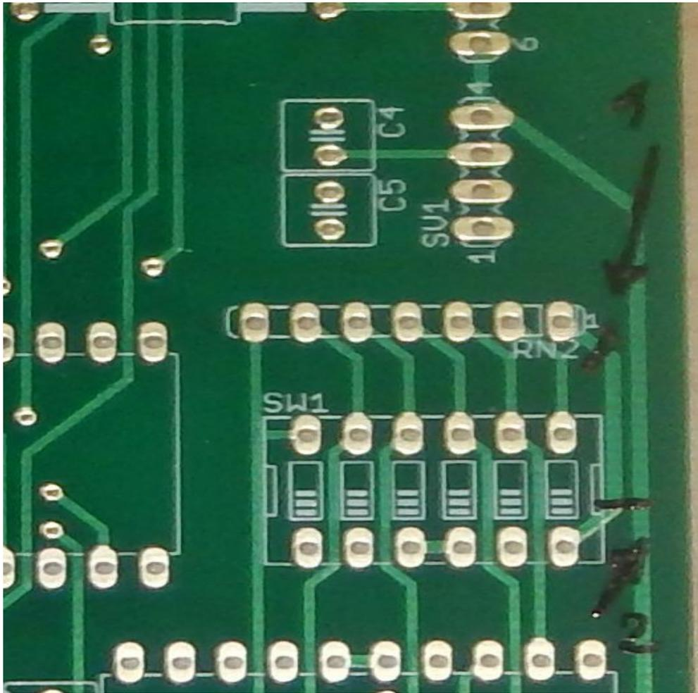
Fehler der Platine: 1 Leiterbahn am RN2 Widerstand trennen
